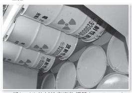
▲低レベル放射性廃棄物埋設センターでの 埋設方法が実物大で紹介されていました。 1992年に操業開始したこの施設は、最終 的に300万本のドラム缶を埋設でき、現 在約31万本が受入済みとのことです
